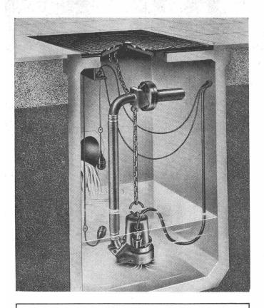
Vertikale Abwassertauchpumpe Robot Modell RW
