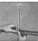
Bild 2. Langen Bandteil sauber um das Rohr biegen, so dass dasselbe ganz umschlossen ist.
