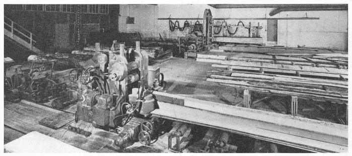
Mechanisiertes Blockband- und Vollgattersägewerk Obrecht AG in Reichenau GR («Brenta»-Blockbandsäge mit anschliessendem Sortierrollengang; vollhydraulisches «Linck»-Vollgatter). Planung, Lieferung und Montage durch die Fischer-Süffert AG, Spezialmaschinen für Holzbearbeitung, Basel
