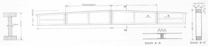
Bild 4 (links). Schematische Darstellung eines Biegeträgers aus Spanplattensteg und Massivholzgurten
