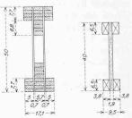
Bild 7. Links: Geleimter Träger, Stege aus Hartfaserplatten, Gurten aus verleimten Brettern. Rechts: Geleimter Träger mit Steg aus Holzspanplatte
