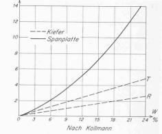
Rechts: Bild 2b. Quellung einer Spanplatte senkrecht zur Plattenebene
