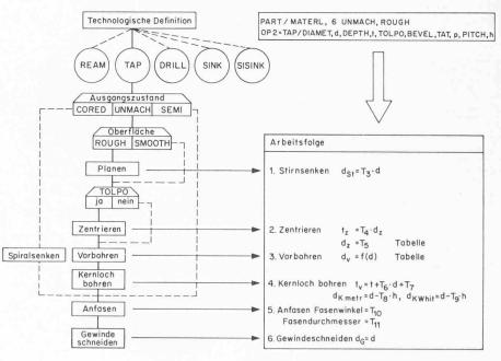
Bild 5. Ermittlung der Arbeitsfolge beim Gewindeschneiden (EXAPT 1)
