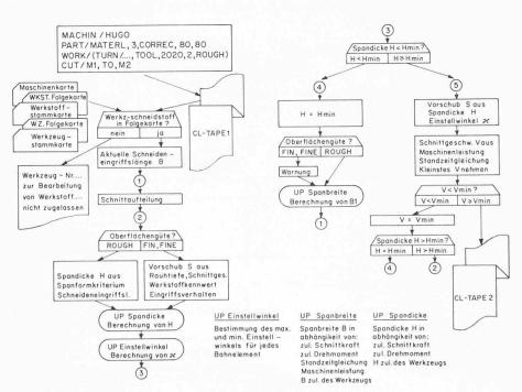
Bild 7. Ermittlung optimaler Schnittbedingungen beim Drehen
