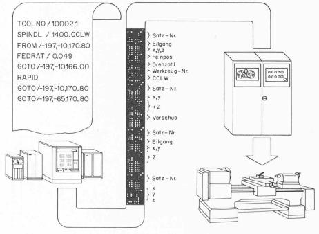
Bild 1. Rechnergestützte Programmierung von NC-Maschinen
