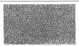
Geschlossene Zellstruktur. In einem speziellen Extrusionsverfahren entsteht ein Hartschaum mit vollkommen geschlossenen Zellen und einer hochverdichteten Oberfläche.
