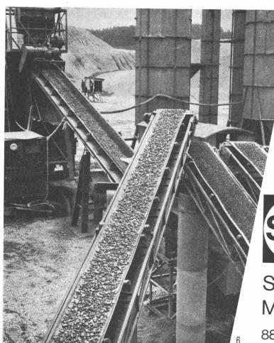
Die Belags- und Betonproduktion kann durch Einsatz geeigneter Förderbänder entscheidend rationalisiert werden. Hier verhelfen SSS-Förderbänder, zentral ferngesteuert und unaufhörlich strapaziert, zu einer konstanten hohen Produktion.
