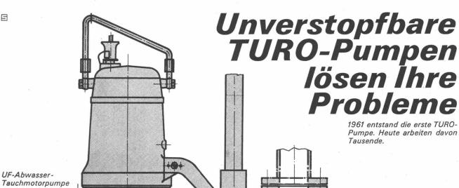
UF-Abwasser-Tauchmotorpumpe für stationären Ein-
