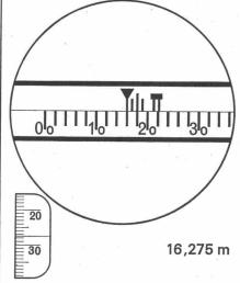
Als Doppelbild-Distanzmesser modernster Bauart ist der DK-RT das geeignete Instrument für die Katastervermessung. Die Distanzablesung ist dank der nonienlosen Meßlatte besonders einfach. Ein Vorsatzkeil ermöglicht die Korrektur des persönlichen Fehlers. Mittlerer Distanzmeßfehler auf 100 m:
