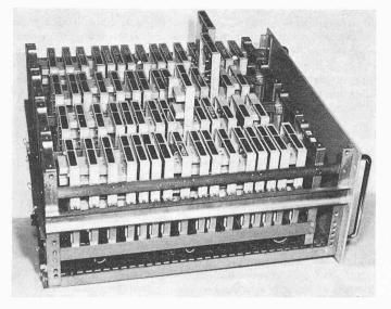
teil mit elektronischer Sicherung: Spannungen Elektronik + 6 V, - 12 V; Spannung Relaisteil 48 V
