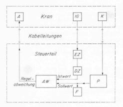
Bild 33. Schematische Darstellung einer Regelung für eine Dimension (Kran)
