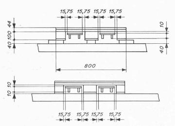
Bild 21. Verfügbarer Freiraum zwischen Pool-Palette und Teleskopgabel, oben mit, unten ohne Unterlagen an den Palettenfüssen
