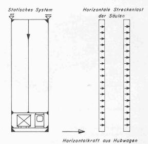
Bild 24. Ermittlung der Kräfte an der Rahmenkonstruktion
