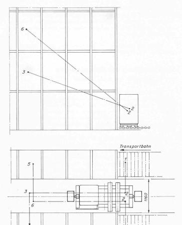
Bild 20. Transportablauf in einem Regalgang
