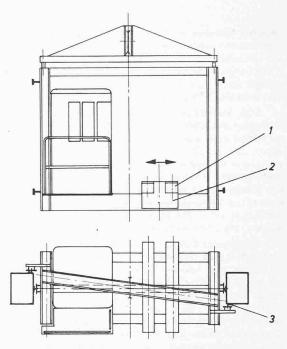
Bild 28. Hubwagen des Stapelaggregates. 1 Teleskopausfahreinrichtung, 2 Schlitten mit Hubwagen, 3 Führungswinkel
