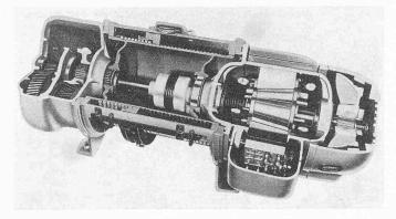
Bild 26. Schnittmodell des verwendeten Elektrozuges, jedoch ohne Feinhub
