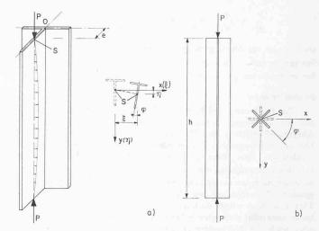
Bild 14. Torsionsknicken und -kippen, a beim T-Element, b beim + -Element
