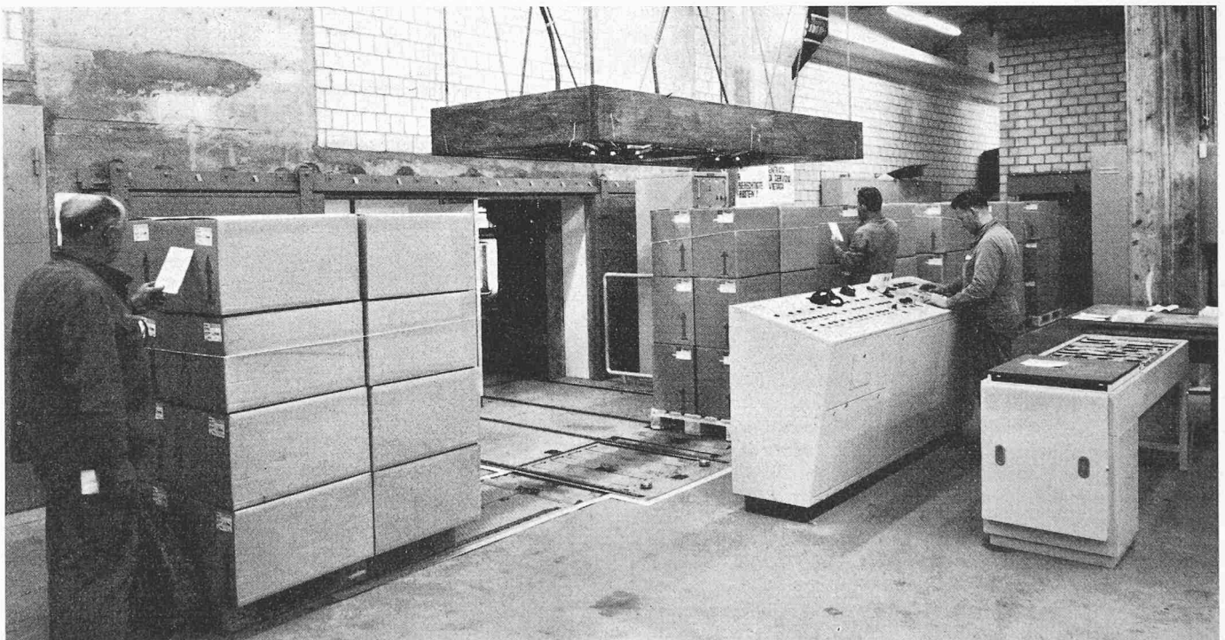
Bild 4. Lagereingang mit Steuerpult. Die Palette wird vor dem Einlagern mit einer photoelektrischen Einrichtung auf Masshaltigkeit geprüft
