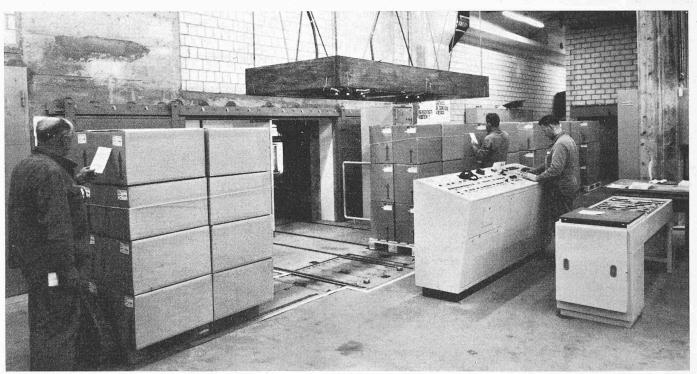
ersten Ausbaustufe beidseitig zweier Gänge (Länge 65 m, Höhe 29,3 m, Breite 1,61 m, Bild 5) angeordnet. Jeder Gang wird durch einen Einschienen-Hängekran mit 27,5 m Hubhöhe bedient. Die Kranbewegungen werden über ein Steuerpult automatisch gesteuert.
