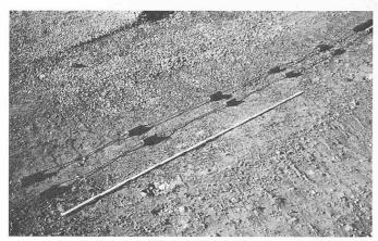
Bild 3. Sprengversuche im Steinbruch der Jura-Cement-Fabriken, Wildegg. Sprengladungen mit Knallzündschnur für schonendes «Hohlraumschiessen»
