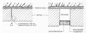
Bild 15. Vorschläge für die Abdichtung von Ringfugen
