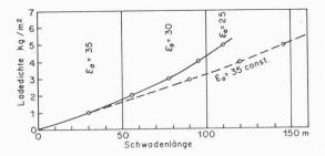
Bild 17. Schwadenlänge als Funktion der Ladedichte, d. h. des Sprengstoffaufwandes pro Quadratmeter Stollenquerschnitt
