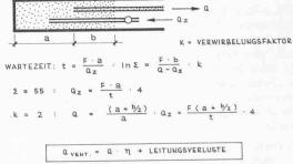
Bild 18. Dimensionierung der Ventilation
