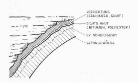
Bild 12 (links). Gespritzte Dichtungshaut
