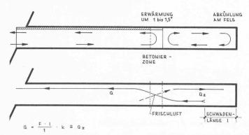
Bild 19. Natürliche Luftströmung in hohen Tunnelprofilen (oben) und entsprechende Anordnung der Ventilationsleitungen (unten)
