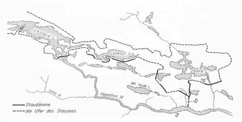
Bild 15. Die Baustelle des geplanten Grosskraftwerkes auf dem Hamilton-Fluss in Labrador. Die geplante Leistung beträgt 4,5 bis 4,7 GW, das Nutzgefälle 320 m.
