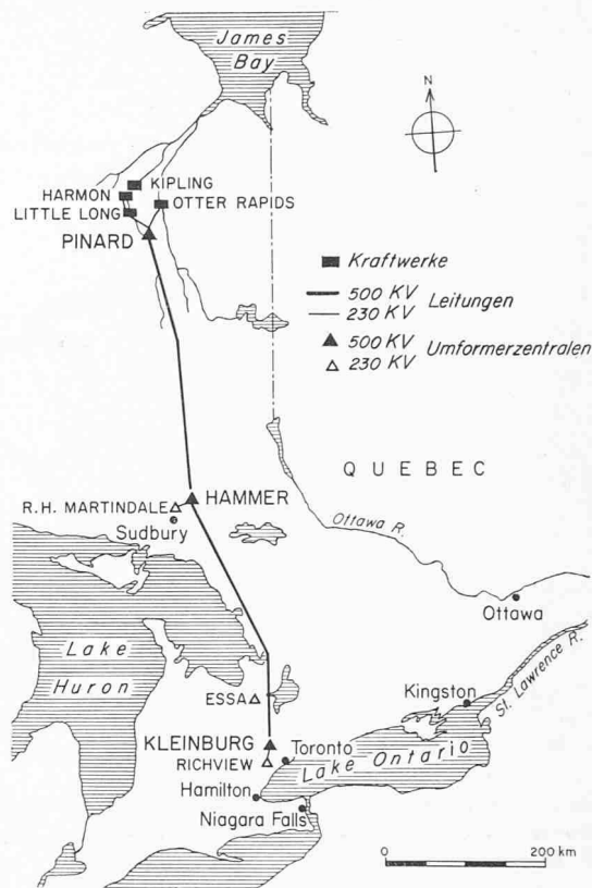
Bild 8. Die 500-kV-Hochspannungslinie von der Kraftwerkgruppe am James-Golf bis zum Toronto-Gebiet
