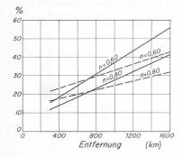
Bild 5. Energieübertragungskosten bezogen auf die Gestehungskosten der Wasserenergie.
