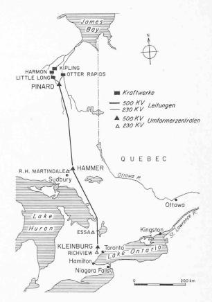
Bild 8. Die 500-kV-Hochspannungslinie von der Kraftwerkgruppe am James-Golf bis zum Toronto-Gebiet
