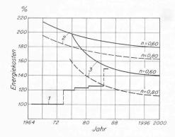
Bild 3. Voraussehbare Entwicklung der Energiekosten an den Verbrauchsstellen (in relativen Zahlen)
