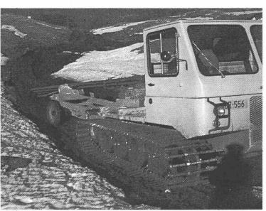
penfahrzeuge befördern bis zu 1000 kg Nutz-last schnell und sicher zum Bestimmungsort (ein Mehrfaches kann nachgeschleppt werden).
