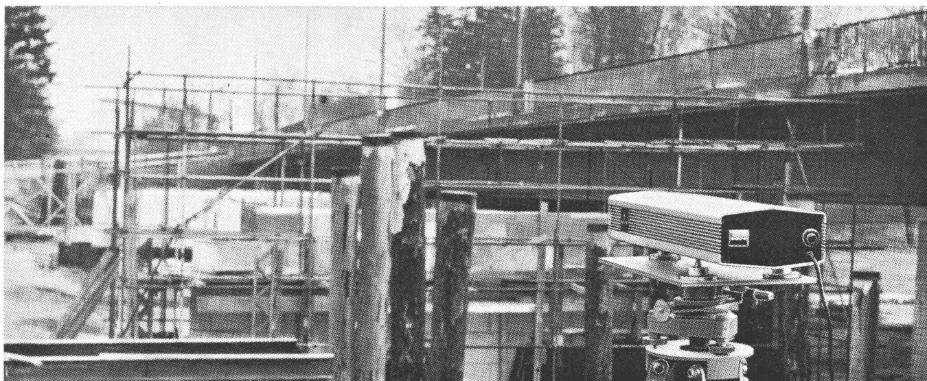
Siemens-Gas-Laser als optische Messhilfe auf einem Bauplatz
