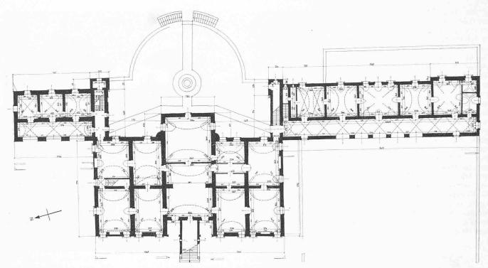
Grundriss des Hauptgeschosses 1:500. «Il Piano nobile... contiene una Loggia e due Terrazzine scoperte, una Sala ed otto Stanze»
