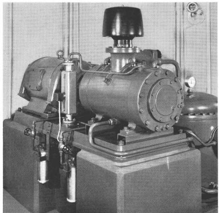
Wassergeschmierter Rotationskompressor zur Erzeugung von 800  $\text{Nm}^3/\text{h}$  ölfreier Druckluft von 4 atü
