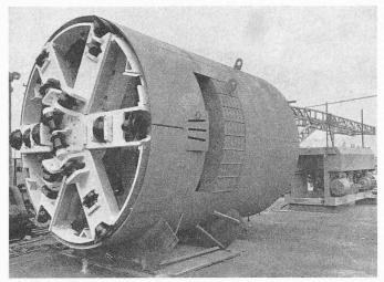
Bild 5. Calweld-Bohrsystem
