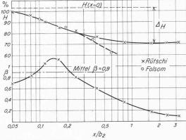
Bild 3b. Förderhöhe H der Versuchspumpe und Erfahrungsgrösse  $\beta=(\triangle\,H\,/\,H)\,/\,(x\,/\,b_{\rm 2})$  beim Förderstrom  $V_{\eta\,m\,ax}$ , in Abhängigkeit von  $x\,/\,b_{\rm 2}$
