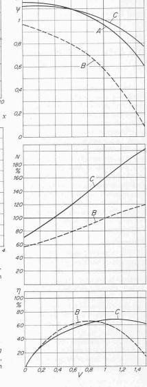
stark an, so dass der Wirkungsgrad wiederum nur ungefähr <sup>2</sup>/<sub>3</sub> desjenigen einer Kreiselpumpe mit normalem Spaltspiel erreichte. Zu beachten ist, dass normale Kreiselpumpen mit radialen Laufradschaufeln bei sonst gleichen Abmessungen auch einen grösseren Förderstrom ergeben.
