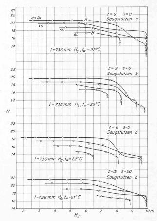
Bild 19. Der Einfluss der Saughöhe  $H_s$  auf die Förderhöhe H bei verschiedenen Förderströmen V (30 bis 60 l/s). Die Freistrompumpe erreicht grosse Saughöhen. Der Saugeinlauf b und niedrige Schaufelzahlen ergeben eine Verschlechterung; der Abstand s bleibt ohne Einfluss
