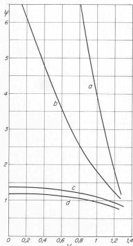
Bild 7. Druckziffer  $\psi$  in Abhängigkeit vom spezifischen Förderstrom  ${\mathcal V}$
