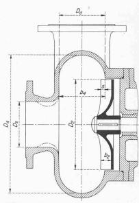
Bild 10. Versuchspumpe mit verschiebbarem Laufrad, mit welcher Untersuchungen ohne und mit stauender konzentrischer Radbegrenzung durchgeführt wurden
