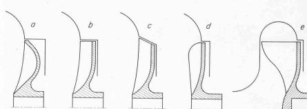
Bild 9. Verschiedene Bauformen von Freistrompumpen
