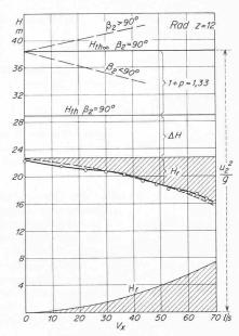
Bild 23a. Berechnete Minderleistung 1 + p = 1,33 für z = 12
