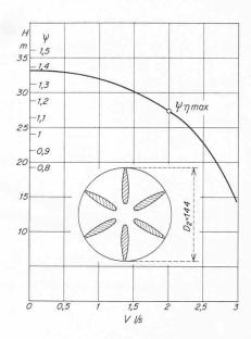
Förderhöhe H in Abhängigkeit vom Volumen-Förderstrom V (Drosselkurve) einer Kreiselpumpe mit  $\beta_2 = 90^\circ$  und  $D_2 = 144$  mm
