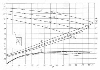
Bild 16. Der Einfluss der Radbreite  $b_{\mathbf{2}}$
