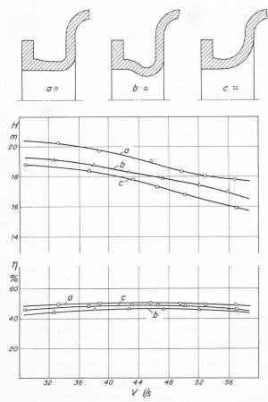
Bild 18. Der Einfluss der Saugeinlaufform auf Förderhöhe H und Wirkungskreis  $\eta$
