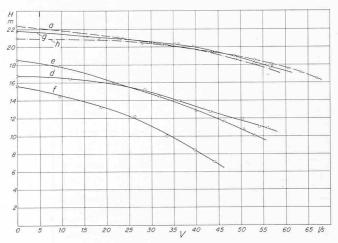
Bild 17. Drosselkurven der Räder a bis h nach Bild 11 d h Laufrad а 90 0 90 0 90 0 30 ° 70 ° B2 12 8 7 5 12 12 Z 49,8 47,6 48 48,4 47,8 49,3  $\eta_{max}$
