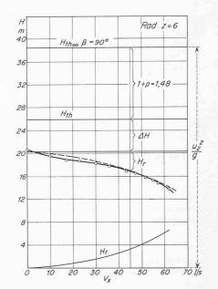
Bild 23b. Berechnete Minderleistung 1 + p = 1,48 für z = 6
