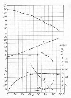
Bild 22. Verlauf der Grössen H,~N und  $\eta$  sowie der für das Saugverhalten massgebenden Grössen  $S,~H_s$  und  $\triangle h_{ges}$  in Abhängigkeit vom Förderstrom V bei der Versuchspumpe mit z=9,~s=0 (Bild 19 oben). Für  $S,~H_s$  und  $\triangle h_{ges}$  wurden die Werte kurz vor dem Steilabfall der Kurven eingesetzt
