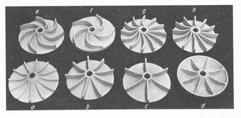
Bild 11. Untersuchte Laufräder B2 BI 90 0 90 0 90 0 90 0 90 0 90 0 90 0 90 ° 30 ° 90 0 30 ° 75 ° 112 0 30 ℃ 12 90 0 30 °
