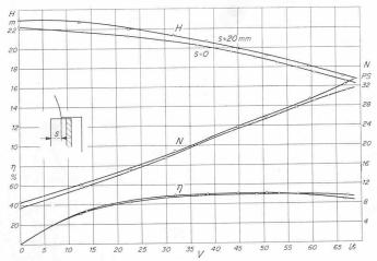
Bild 12. Der Einfluss der konzentrischen Begrenzung (bzw. des seitlichen Abstandes  $\emph{s}$ ) bei einem Laufrad mit  $\emph{z}=$  12
