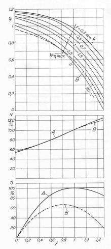
Bild 2. Druckziffer  $\psi=2$  g  $H/u_2^2$  für verschiedene Werte von x, Leistungsbedarf N und Wirkungsgrad  $\eta$  in Abhängigkeit vom Förderstrom V. A bei x=0.3 mm; B bei x=20 mm;  $\psi_{\eta max}=\psi$ -Werte bei bestem Wirkungsgrad
