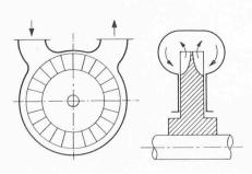
Bild 6. Seitenkanalpumpe mit Zirkulationsströmung
