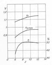
Bild 14 (links). Druckziffer  $\psi$  und Wirkungsgrad  $\eta$  in Abhängigkeit von der Schaufelzahl z beim Nullförderstrom  $V_0$  und beim Förderstrom besten Wirkungsgrades  $V_{\eta max}$
