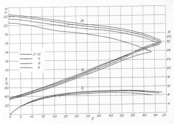
Bild 13. Der Einfluss der Schaufelzahl z bei s=0
