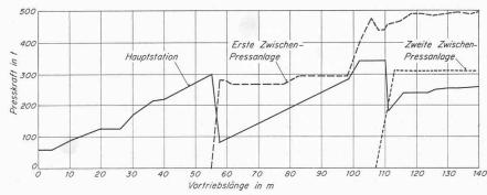
Bild 9. Graphisch dargestellte Wirkungsweise von zwei Zwischenpress-Stationen bei einer totalen Stosslänge von 140 m
