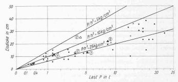
Bild 2. Eisdicken auf Seen und Flüssen, bei denen Einzellasten getragen wurden, bzw. durchgebrochen sind (leere, bzw. ausgefüllte Signaturen)
