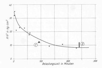
Bild 3. Beobachtungen über die Zeitspanne, nach der gewisse Lasten bei unterschiedlichem Faktor P/h² durchs Eis gebrochen sind, nach Assur [4], Fig. 1, Seite 919, ergänzt durch das Resultat des Belastungsversuches vom 30. Januar 1963 auf dem Zürichsee; 1 Belastung mit 7 Fässern ohne Berücksichtigung der Vorbelastung mit 5 Fässern, 2 mit Berücksichtigung der Vorbelastung
