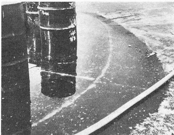
Bild 1. Belastungsversuch auf dem Zürichsee in fortgeschrittenem Stadium. Kreuzungsstelle von Radial- und Tangentialriss (Kreisriss)
