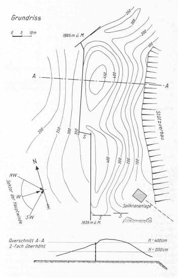
Bild 3. Triebschneeablagerungen am 14. April 1967 im Bereich der Triebschneewände OeAM (H = 400 cm) auf Fachswang, Lawinenverbauung Tanngrindel, Brienz. Die Triebschneewände stehen ungefähr in der Hangfall-Linie und mehr oder weniger senkrecht zur Hauptwindrichtung. Die mittlere Hangneigung im Bereich der Triebschneewände beträgt 29 °. S = Schneebrücken mit Füllungsgrad min. 65 %
