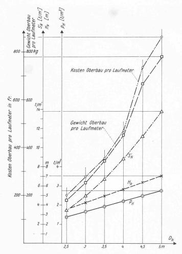
Bild 4. Werk- und Schneehöhen, Schneedruckgrössen, Laufmetergewichte und Preise, dargestellt an Stahl-Schneebrücken OeAM verschiedener Werkgrössen
