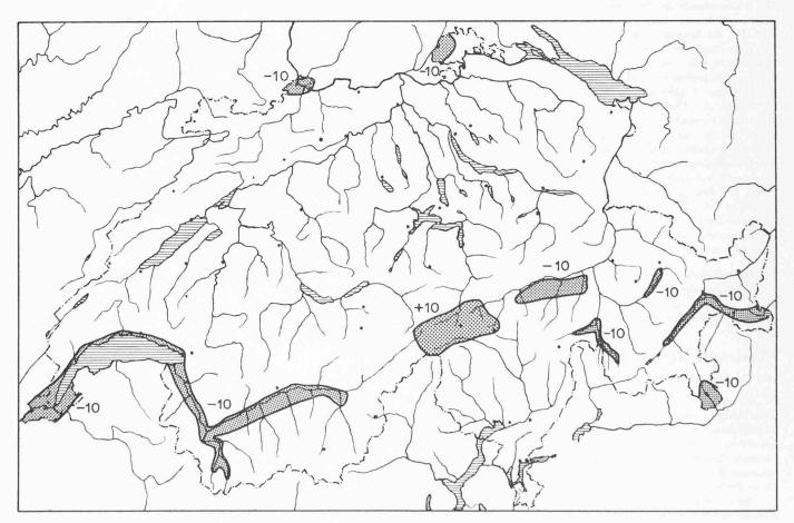
Bild 2. Abweichungen der maximalen Schneelasten in Prozenten in der Schweiz
