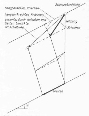
Bild 1. Schematische Darstellung der Kriech- und Gleitbewegung der Schneedecke
