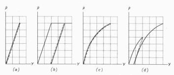
Bild 2. Last-Deformationsgesetze (—— Belastung, ——— Entlastung)
