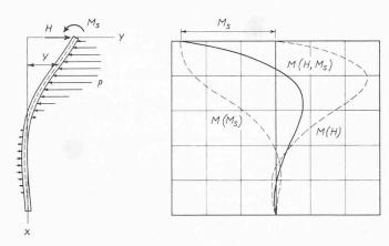
Bild 1. Beanspruchung eines Pfahles durch Horizontalkraft H und Einspannmoment  $M_8$ ; Momentenlinie einzeln und superponiert dargestellt
