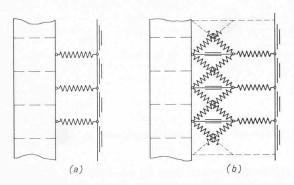
Bild 4. Bodenersatzmodelle (a) ohne, (b) mit Berücksichtigung der Drucküberschneidung
