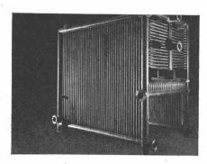
▲ Dieser Heisswasserkessel Typ HWC 50 ist einer der drei von uns für die neue Heizzentrale des Flughafens Genf-Cointrin gelieferten Eckrohrkessel. Das Bild zeigt den Rohrkäfig ohne Verschalung, mit Strahlungs- und Berührungsheizflächen.
