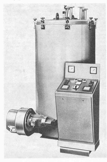
isoliert und zusätzlich mit Verbrennungsluft gekühlt. Der Kesselkörper, Bild 1, an den im unteren Teil die Kombination Motor, Verbrennungsluftgebläse und Heizölpumpe tangential angebaut ist, steht auf einem Profilrahmen. Ein besonderes Fundament ist deshalb nicht erforderlich. Die Vor- und Rücklaufanschlüsse sind durch den Kesseldeckel geführt.
