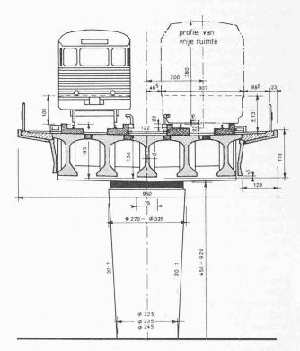
Bild 5. Hochbahnviadukt, Querschnitt 1:125
