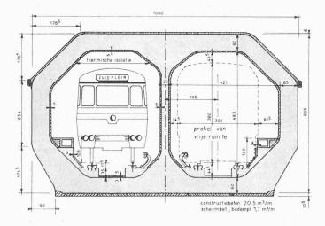
Bild 4. Flusstunnel, Querschnitt 1:125
