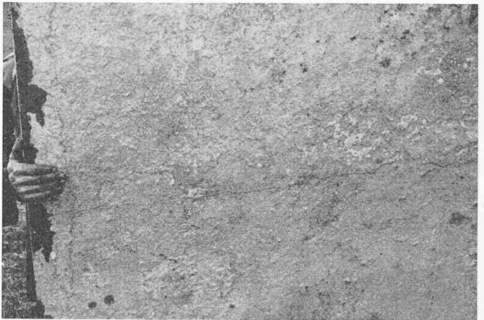
Platte 2 nach der Sprengung
