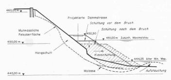
Bild 2. Aarekraftwerk Aarberg, Staugebiet. Die Schüttung der Dammstrasse quetscht weiche Molasseschichten aus
