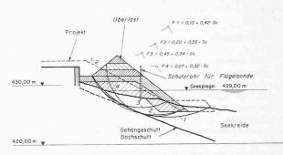
Bild 4. N 5, Bielerseestrasse. Eine Versuchsschüttung mit steiler Böschung soll die Messung der Scherfestigkeitszunahme infolge Konsolidation der Seekreide ermöglichen. Die Messung erfolgt mit Hilfe der Flügelsonde
