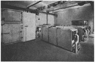
Beton-Frostanlage in der Empa
