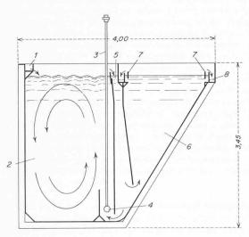
Bild 1. Schnitt durch die Rheinstahl-Kläranlage (schematisch)
