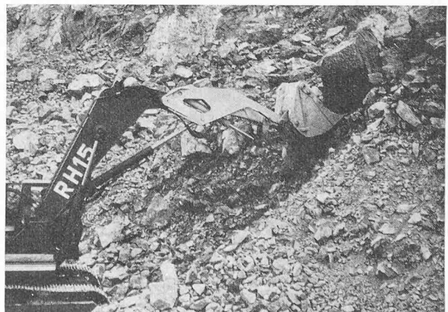
Bild 1. Das Herauslösen eines Knäppers aus der Böschung
