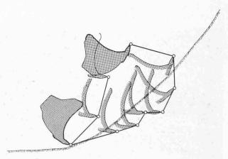
Bild 7. Die Kinematik des Löffels beim Graben vom Böschungsfuss aus (Bildabstand jeweils 1 s)
