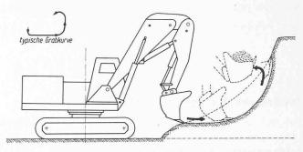
Bild 4. Die Arbeitsweise des Hydraulik-Baggers
