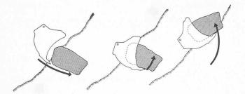
Bild 2. Das «Knippen» (Herausbrechen des Haufwerks) beim Hydraulik-Bagger mit angelenktem Löffel
