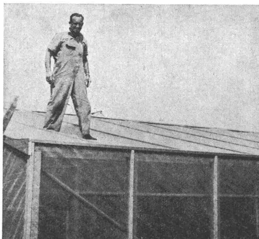
dank Gitterarmierung erstaunliche Reisskraft
