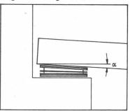
Die FD-Gleitfolien übernehmen die Gleitung – z. B. aus temperaturbedingten Dehnungen –, und die Aufpolsterung aus Neoprene mit Edelstahl wird ausschließlich mit dem Ausgleich einer Bauteilverkantung am Auflager – etwa aus der Durchbie-
