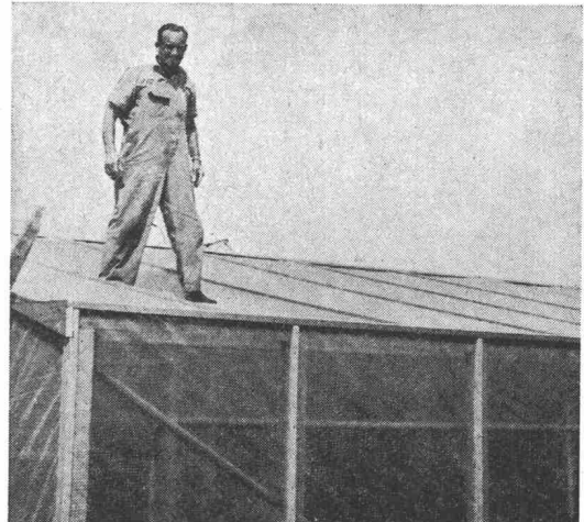
dank Gitterarmierung erstaunliche Reisskraft
