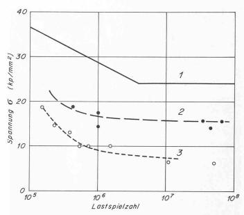
Bild 6. Dauerfestigkeitsschaubild von Gusseisen mit Kugelgraphit
