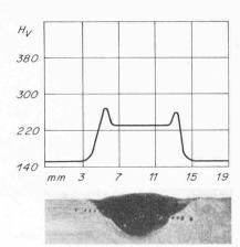
Tabelle 1. Eigenschaften von Stumpfschweissnähten an Sphäroguss nach BS. 2789 mit Elektroden Type Ni 55-Fe
