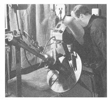
Bild 8. Automatisches Schweissen eines Stahl-Führungsrohres an einem Lenkgehäuse aus Gusseisen mit Kugelgraphit, Werkbild Burmann & Sons Ltd., Birmingham
