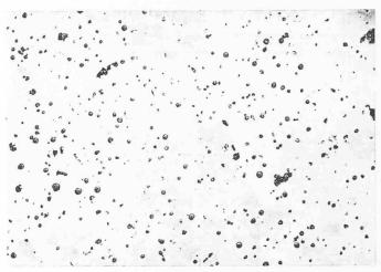
Bild 5. Typisches Gefüge eines Ni-Fe-Schweisszusatzwerkstoffes, ungeätzt
