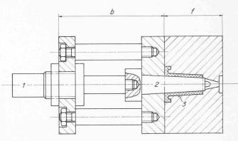
Bild 5. Druckgiessform mit bewegtem Kern, b bewegliche Formhälfte, f feste Formhälfte; 1 Kernzugzylinder, 2 Kern, 3 Gussteil
