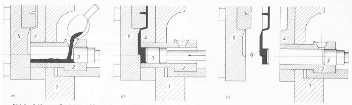
Bild 3. Kaltkammer-Druckgiessverfahren mit waagrechter Druckkammer. a Einfüllstellung: Maschine geschlossen, Presskolben in Einfüllstellung; b Einpressvorgang; c Ausstoss-Stellung
