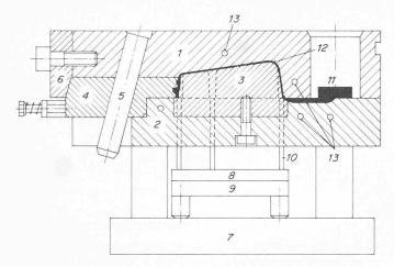
Bild 4. Schnitt durch eine Druckgiessform mit Seitenschieber
