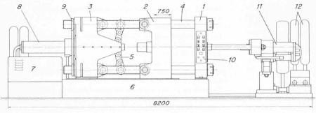
Bild 1. Kalt-Kammer-Druckgiessmaschine von 800 Mp Schliesskraft
