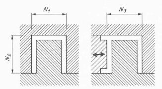
Bild 8. Schematische Darstellung verschiedener Massarten im Hinblick auf die erzielbaren Toleranzen im Druckgussteil
