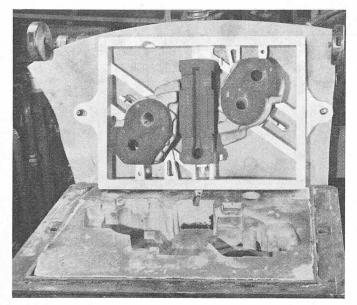
Bild 18. Kern-Eindecklehre mit eingespannten Kernen
