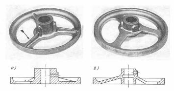
Giessgerechte Konstruktion eines Friktionsrades
