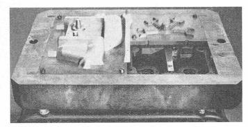
Bild 14. Maschinenformeinrichtung: Eisenrahmen mit Wechselplatten für die automatische Formherstellung auf einer Hochdruckpresse. Das Wechseln der Formplatte von 1/1, 1/2 oder 1/4 Grösse beansprucht nur wenige Sekunden
