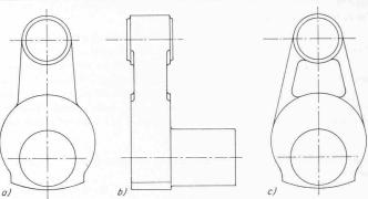
Bild 16. Exzenterhebel, bei dem durch Verlegung einer ungünstigen Modelltrennung die Putzkosten vermindert wurden. Putzzeit bei a 100 %, bei b 81 %, bei c 63 %
