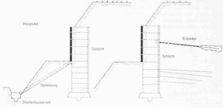
Bild 4. Schachtwand für die Garage an der Monbijoubrücke in Bern, Schnitte 1:400
