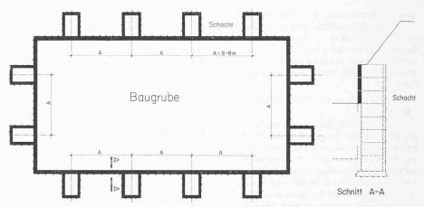
Bild 1. Prinzip des Schachtwandverfahrens, Grundriss und Schnitt 1:400
