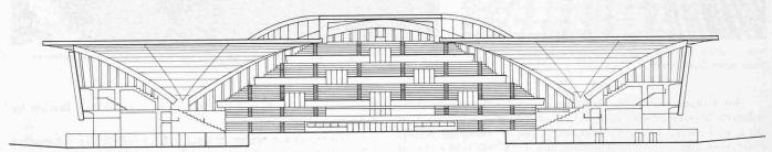
Bild 10. Querschnitt durch die grosse Eishalle, Achse der kleinen Gewölbe, 1:1000
