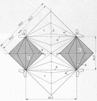
Bild 16. Schematischer Grundriss der Gewölbe, 1:2000 1 grosses Gewölbe, 2 kleine Gewölbe (durch Raster hervorgehoben), 3 Scheitelfugen, 4 Gewölbefugen, 5 Stützen, 6 Zugstangen, 7 Streben
