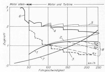
Bild 4. Zugkraft am Radumfang in Abhängigkeit von der Fahrgeschwindigkeit
