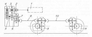
Bild 3. Schema der mechanischen Drehmomentübertragung von der Turbine auf die Triebachsen
