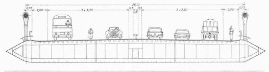
Bild 12. Versteifungsträger, Querschnitt 1:250
