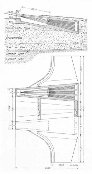
Schnitter weist in seinen Vorlesungen an der ETH immer wieder darauf hin, dass der gute Ingenieur auch den Baugrund als Konstruktionsteil seines Bauwerkes betrachten und somit die Konstruktionstund Gründungsprobleme immer als Ganzes sehen muss. In diesem Falle wurde die Kieslage von hoher Scherfestigkeit zum notwendigen Bestandteil der Brücke. Sie verteilt die Scherkraft am Übergang zur Lehmschicht auf eine weit grössere Fläche und macht diese Art Kabelverankerung erst möglich.
