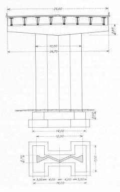
Bild 16. Gewellte Stützen, eine dänische Erfindung! Die Pfeiler der Zufahrtsbrücke vereinen Phantasie mit statischem Geschick
