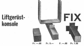
Die Liftgerüstkonsole «Fix» ist baupolizeilich bewilligt worden. Die seitlichen Konsolenschenkel sind 10 cm hoch, ein Umkippen der Hölzer unmöglich. Durch seitliche Stiftlöcher für Nägel werden gleichzeitig die Hölzer und Konsolen gesichert. Durch keine Ueberhöhung behindert, entsteht ein vollständig ebener Gerüstboden. Einfachstes und sicheres System. Andere Konsolengrössen können jederzeit angefertigt werden. — Günstige Preise.
