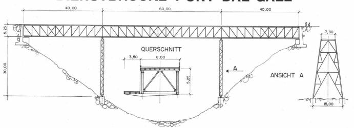
KONSTRUKTION: Stahl verschraubt. EIGENGEWICHT: G = ca. 350 t NUTZLAST: P =  $3\times21$  t in Abständen von 7,00 m oder p = 350 kg/m² (Schnee)
