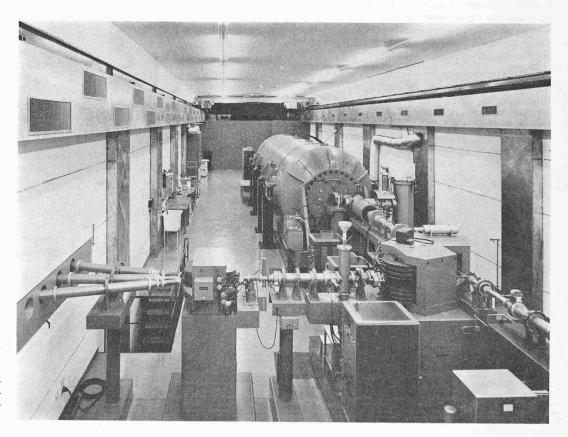
Bild 12. Laboratorium für Kernphysik. Unterirdische Maschinenhalle mit «Tandem-van-de-Graaff»-Beschleuniger
