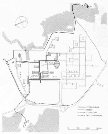
Vom Hilfsbetriebstrakt der Energiezentrale, wo sich Messstation und Hauptverteilung befinden, führen die Fernleitungen zu den einzelnen Gebäuden der Aussenstation. Ebenfalls im Hilfsbetriebstrakt ist die Anlage für die Wasseraufbereitung eingerichtet; sie liefert teilentsalztes Wasser, mit dem die heizungs- und lüftungstechnischen Anlagen gespeist werden, und ganzentsalztes Wasser für den Bedarf der Laboratorien.
