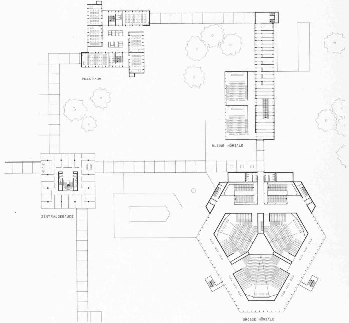
Bild 22. Unterrichtsbauten (Kote 535,70 m), 1:1000: Physik-Zentralgebäude, grosse Hörsäle (mit Draufsicht Studentenrestaurant), kleine Hörsäle und Praktikum
