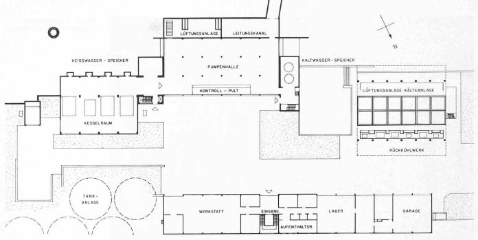
Bild 30. Energiezentrale. Erdgeschoss (Kote 510,00 m) 1:900 (links oben: Hochkamin)
