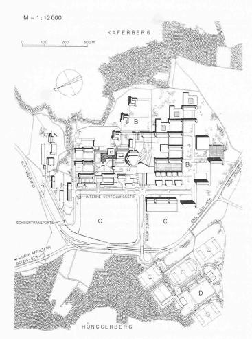
Bild 2. Das Ausführungsprojekt 1:12000 mit skizzierter Darstellung von Erweiterungsmöglichkeiten (physikfremde Institute, Unterrichts- und Gemeinschaftsbauten usw.) in späteren Ausbauetappen. A Ausbauprojekt, B Erweiterungsmöglichkeit, C Randreserve, D Vorschlag einer eventuellen Sportanlage unter Beteiligung der Stadt Zürich (Diplomarbeit an der Abteilung I der ETH)
