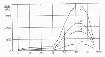
Bild 8. Spezifischer Wärmeeinfall durch ein Fenster mit Verbundglas auf der Westseite infolge Sonnenstrahlung an einem heissen Sommertag in Abhängigkeit von der Tageszeit; Höhenlage und Dunstfaktor sind berücksichtigt, nach [1]
