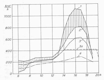
Bild 9. Wärmeeinfall und abzuführende Wärme pro Fensterachse wie Bild 8, Kurve 2 bzw. 3. Grösse der Achse 1,9  $\times$  3,6 m, Grösse des Fensters 1,8  $\times$  2,2 m, Grösse der Brüstung 1,9  $\times$  0,8 m, k-Wert 1,0 kcal/m² h ° C; keine Beschattung durch Sturz und Leibung
