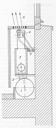
Bild 11. Nachwärmauslass mit Schalldämpfer
