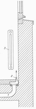
Bild 10. Nachwärmsystem mit Zentralheizung
