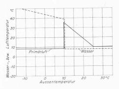
Bild 5. Verlauf der Primärlufttemperatur und der Betriebswassertemperatur im Zweirohr-Umschaltsystem in Abhängigkeit von der Aussentemperatur
