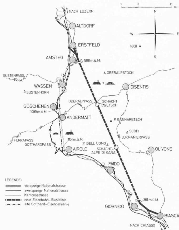
Bild 17. Variante C, Übersichtsplan. Basistunnel für Eisenbahn und Strasse. Der Strassenverkehr verfügt daneben noch über einen Strassentunnel auf der Höhe Göschenen—Airolo und über die Passstrasse
