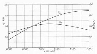
Bild 2. Verlauf der Leistung und des Drehmoments in Funktion der Drehzahl beim «Stamo 30»
