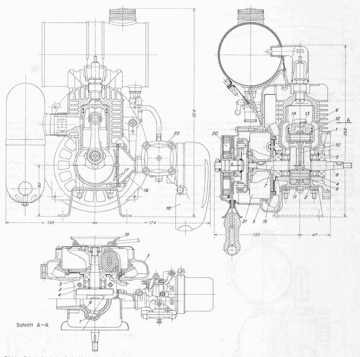
Bild 5. Schnitt durch den Sachs-Motor «Stamo 30» in Normalausführung
