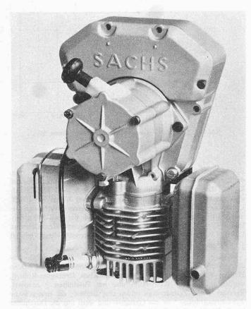
Bild 12. Ansicht des Sachs-Motors «Stamo 51» für Rückensprühgeräte
