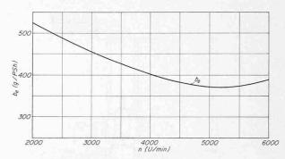
Bild 7. Spezifischer Brennstoffverbrauch des «Stamo 76»
