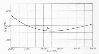
Bild 3. Spezifischer Brennstoffverbrauch des «Stamo 30»
