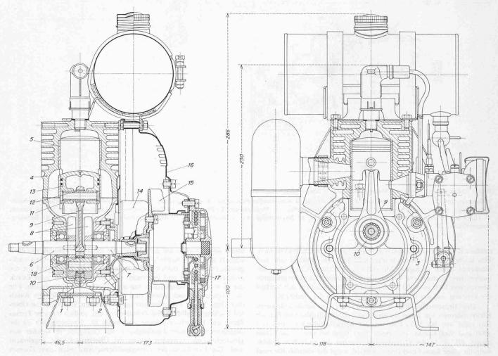
Bild 8. Schnitt durch den Sachs-Motor «Stamo 76» in Normalausführung
