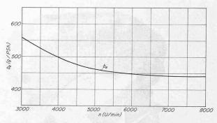
Bild 10. Spezifischer Brennstoffverbrauch des «Stamo 51»
