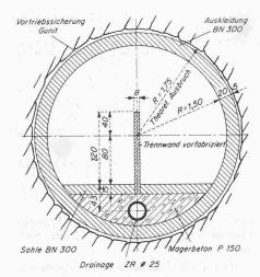
Bild 2. Normalprofil des Stollens, Massstab 1:70. Der Querschnitt passt sich dem kreisrunden Querschnitt von 3,50 m Durchmesser bzw. 9,60 m² an und erlaubt, die maximale Wassermenge (6,30 m³/s bei Regenwetter) abzuleiten. Der ganze Kanal wird konsequent mit einer Trennwand zweiteilig ausgeführt, so dass bei Trockenwetter Kontrollen und Revisionen möglich sind
