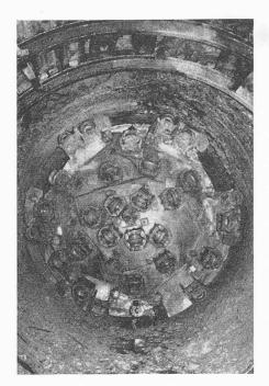
Bild 4. Gesamtansicht Bohrkopf. Die Vorderfront bildet eine kreisrunde Panzerplatte, die mit 28 Rollenmeisseln (Diskusmeisseln) sowie einem Zentralbohrer bestückt ist
