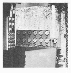
lichen hydraulischen Druck, der am Steuerpult für jede Presse einzeln regulierbar ist. Als Hilfsaggregate dienen zudem ein Kompressor, eine pneumatische Schmierpresse, ein Hilfsventilator sowie die Einrichtungen für eine grosszügige Beleuchtung (Bild 6).
