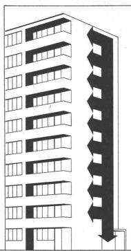
Transistorisierte Tür-Wechselsprechanlage mit uP-Hausstellen und automatischer Abschaltung.
