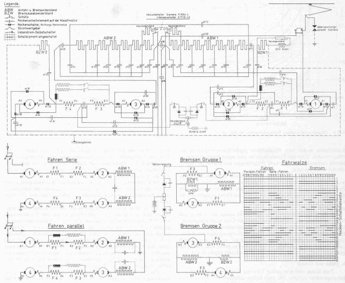
Bild 8. Traktionsschema für den Motorwagen Be 4/4 der BVB
