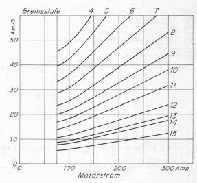
Bild 10. Charakteristik eines Traktionsmotors für Bremsen
