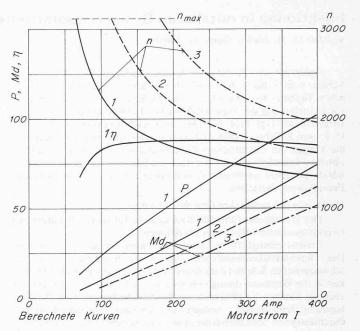
Bild 11. Charakteristische Kurven eines Traktionsmotors
