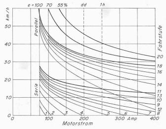
Bild 9. Charakteristik eines Traktionsmotors für Fahren
