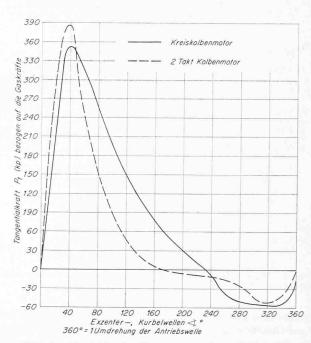
Bild 8. Vergleich der Tangentialkraft-Diagramme beim Einzylinder-Zweitakt-Hubkolbenmotor und beim Einscheiben-Kreiskolbenmotor
