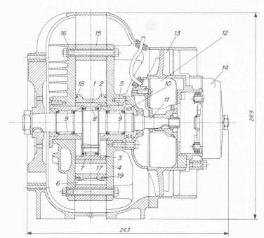
Bild 2. Schnitt durch einen luftgekühlten Kreiskolbenmotor
