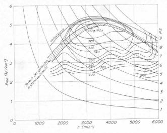
Bild 9. Brennstoffverbrauchs-Kennfeld des Sachs-Kreiskolbenmotors Typ KM 48
