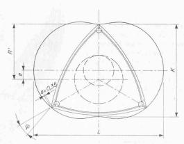
Bild 4. Konstruktionsgrössen zum Kreiskolbenmotor
