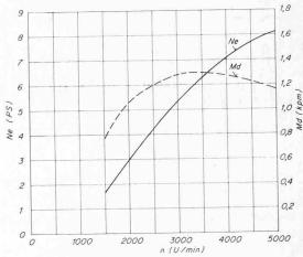
Bild 10. Leistungs- und Drehmomentverlauf beim Sachs-Kreiskolbenmotor KM 48
