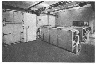
Beton-Frostanlage in der Empa
