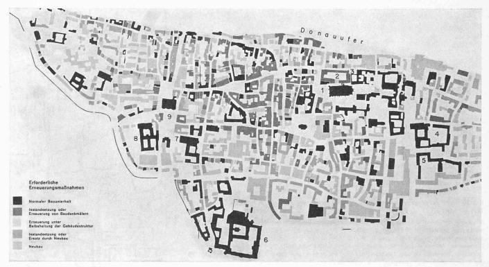
Bild 4. Plan 1:1000 mit Angabe der erforderlichen Massnahmen zur Erhaltung, Instandsetzung und Erneuerung der Altstadt von Regensburg. Bildziffern:
